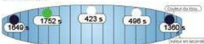
La mesure de la porosité d'une voile revient à mesurer en combien de temps un certain volume d'air passe à travers le tissu. Les mesures exprimées en seconde sont effectuées à l'aide d'un porosimètre JDC MK2 ou HELLO V2. (La mesure de 1s correspond à 5400/m²/min).
